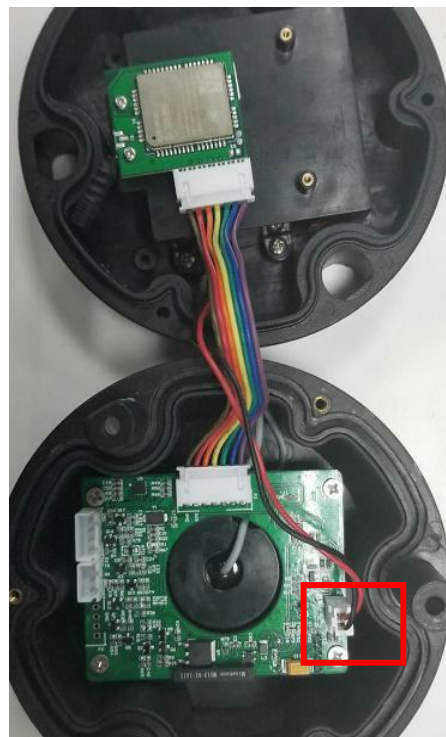
Рис. 6 Батарея подключена к плате
