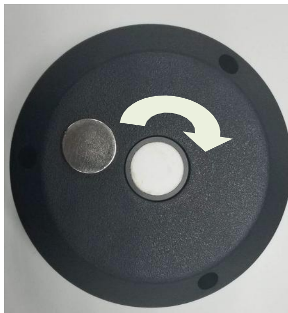
Рис. 4 Перезапуск датчика при помощи магнита
