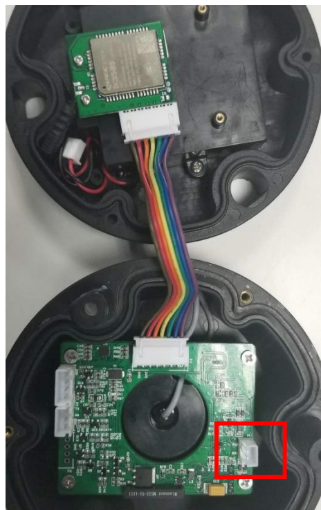
Рис. 5 Батарея не подключена
